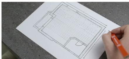
**Mesurez également la largeur de la pièce.** Divisez la largeur de la pièce par la largeur de la planche Allure (côté court). Si le chiffre obtenu est inférieur à la moitié de la largeur de la planche, vous devrez alors couper votre première rangée sur toute sa longueur de façon à ce que la largeur de la première et de la dernière rangée soit la même. Évitez les rangées de moins de la moitié de la largeur de la planche.
