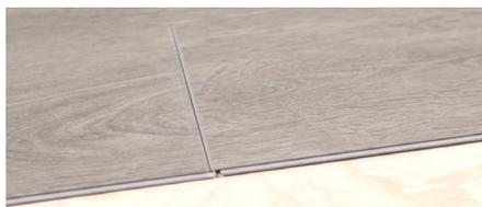
**Assurez-vous que les joints sont bien serrés.** Il ne devrait y avoir aucun écart visible entre les planches. Si le joint n'est pas serré, retirez délicatement la planche supérieure de la planche inférieure en la soulevant délicatement, et réinstallez-la correctement. Retirer trop rapidement les planches pourrait arracher ou endommager les languettes d'emboîtement.
