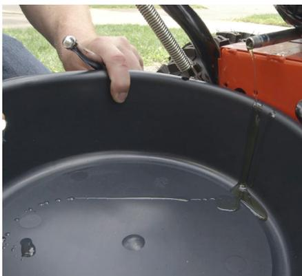
**Commencez par vidanger l'huile et l'essence**, puis mettez-les au rebut avant d'ajouter de nouveaux liquides. La plupart des magasins de petits moteurs et de pièces automobiles offrent des programmes de recyclage gratuits. Si votre machine est équipée d'un moteur quatre-temps, vérifiez le niveau d'huile après chaque période de huit heures d'utilisation. Si votre machine est équipée de filtres à air, remplacez-les aussi.
