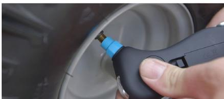
**Examinez les pneus à la recherche de traces d'usure et de perforations.** Si votre machine est équipée de pneus gonflables, utilisez le manomètre pour en vérifier la pression et, au besoin, gonfler les pneus à la bonne pression.
