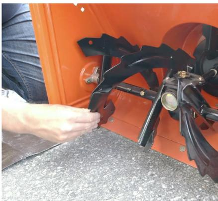
**Lubrifiez régulièrement les pièces mobiles pour assurer leur bon fonctionnement.** Graissez les roulements des roues, de la tarière et de la turbine. Examinez les courroies et le racloir et remplacez les pièces usées.
